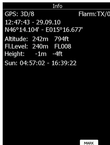
**Altitude** ist die Höhe über NN, **Fl. Level** die Höhe über 1013 hPa und **Height** die Höhe über dem Geländemodell. In der rechten oberen Ecke wird der Flarmstatus angezeigt. TX bedeutet, daß das integrierte Flarm aktuell sendet, die Nummer zeigt die Anzahl der empfangenen Flarmobjekte an.
