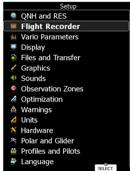
Mit dem **Up/DOWN-Drehschalter** werden die verschiedenen Menüs – Positionen von **QNH and RES** bis **Password** angewählt. Betätigen des Drucktasters bei „Select“ eröffnet den gewählten Menüpunkt.
