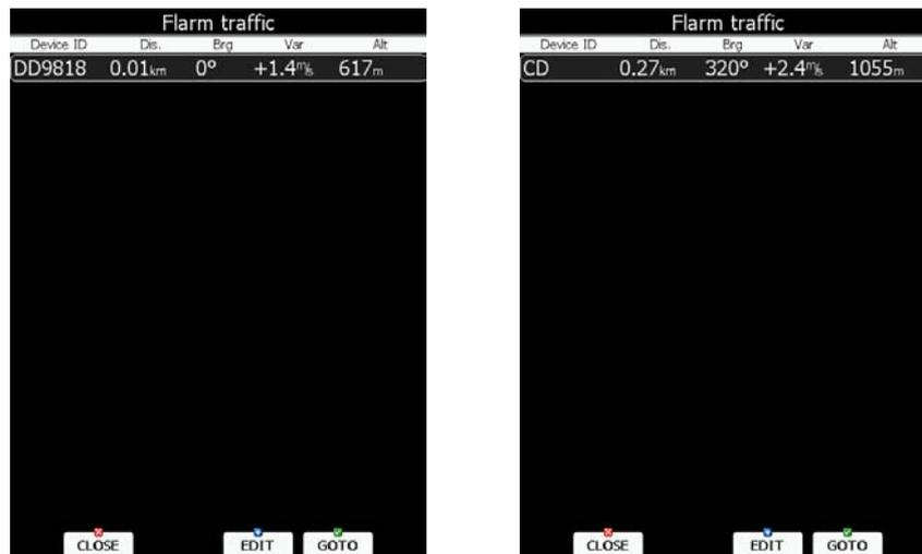
Die Liste ist nach den Entfernungen zu den einzelnen Objekten sortiert. Wählen Sie das gewünschte Objekt aus und drücken Sie **GOTO**, um zu diesem Objekt zu navigieren. Anstelle der FLARM-ID kann man sich auch das Wettbewerbskennzeichen des gewählten Flugzeuges anzeigen lassen. Verwenden Sie **EDIT**, damit gelangen Sie in ein Editiermenü, in dem Sie Daten von Flugzeug und Pilot eingeben können.
