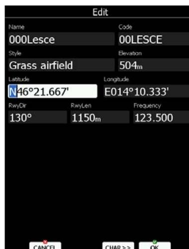
bestimmten Positionen nur ein limitierter Zeichensatz verwendet werden. Dies wird z.B. bei der Eingabe von Werten wie Koordinaten oder Passwörtern verwendet.
