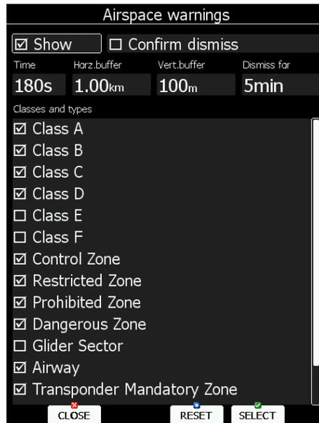
Um einen Luftraum herum definiert der Pilot eine Sicherheitszone mittels der Werte „Horz. Buffer“ (lateraler Abstand, x siehe Bild) und „Vert. Buffer“ (vertikaler Abstand, z siehe Bild).
