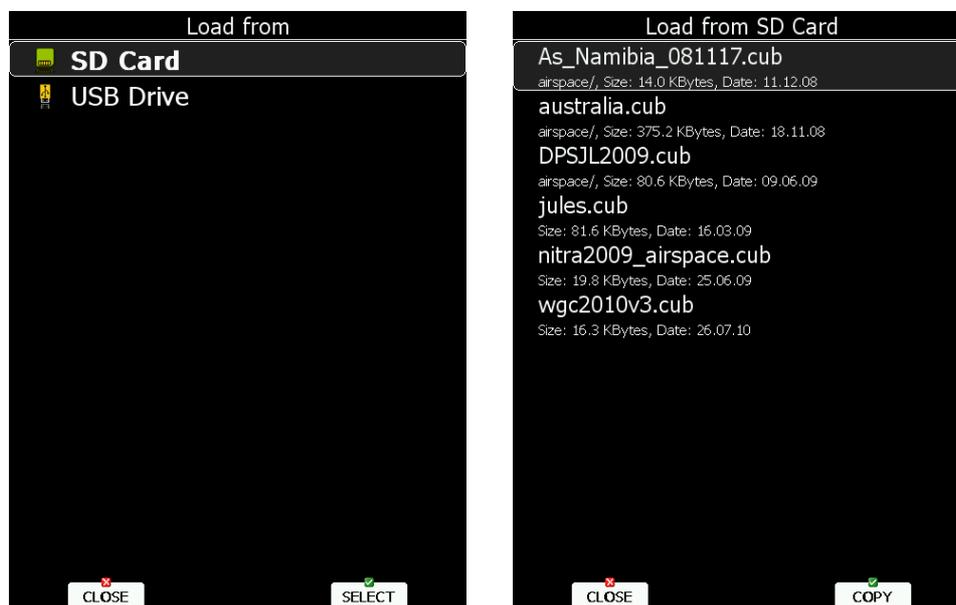
Mit dem Cursor (über UP/DOWN) markiert man die gewünschte Datei und kann mit wieder mit „Copy“ diese in den Speicher des LX9000 kopieren. Ist eine Datei gleichen Namens bereits im Gerät vorhanden, bringt das LX9000 eine Sicherheitsabfrage zum Überschreiben der Datei, die mit Yes oder No beantwortet werden muß. Das Laden von Luftraumdateien von einem angeschlossenen Logger ist derzeit nicht möglich. Mit „Close“ verlässt man das Menü.
