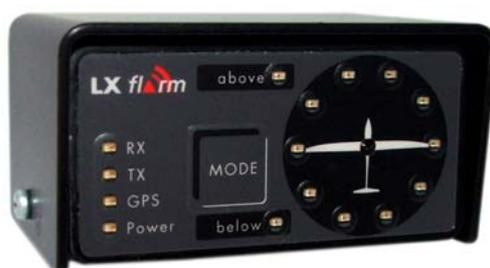
Ist beabsichtigt ein weiteres Navigationsgerät (z.B. PDA) oder das graphische LX-FLARM Display mit den Daten aus dem FLARM zu betreiben, so wird ein Splitter zum Abzweigen dieser Daten benötigt. LX Navigation Deutschland bietet Ihnen die passenden Splitter und Anschlusskabel für Ihren PDA.
