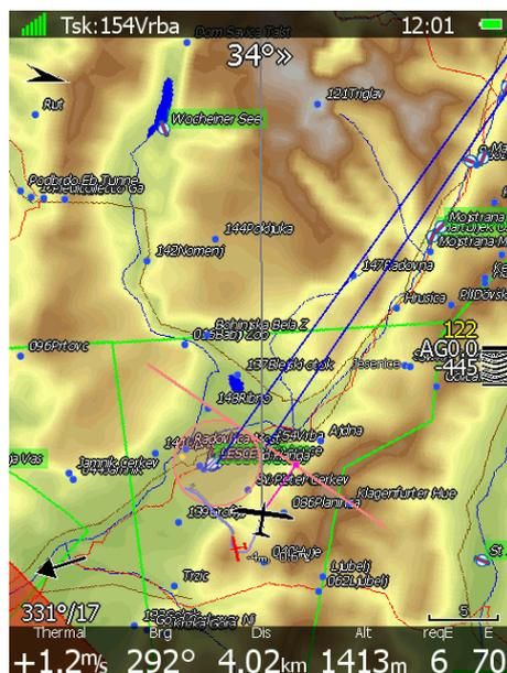
Die untere Zahl gibt die Differenzhöhe, mit der man den, zur aktuellen Position nächstgelegenen Punkt der Linie erreicht, bei der aktuell geflogenen Groundspeed, die in der gelben oberen Zahl angezeigt wird. Bei positiven Differenzhöhenwerten käme man zu hoch an. Die Chevrons geben jetzt an, daß man noch beschleunigen kann, bzw. langsamer fliegen sollte. Auf dem Beispielbild oben ist der Pilot aktuell 122kmh/h über Grund schnell und käme 445m unterhalb der Linie an
