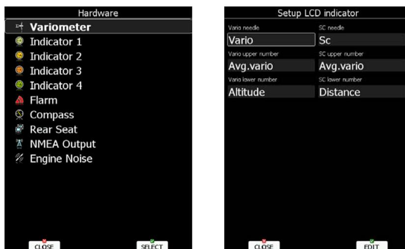
Die Anzeige kann man für VARIO- und Sollfahrt (SC) -Modus unterschiedlich konfigurieren. Programmierbar ist die Funktion des Zeigers und der zwei numerischen Anzeigen. Das bedeutet bei z.B. **Vario needle** (Zeigerfunktion im Variomode) und **SC needle** (Zeigerfunktion in Sollfahrtmode, SC = Speed Command), handelt es sich um den gleichen Zeiger, nur in den verschiedenen Flugmodi.
