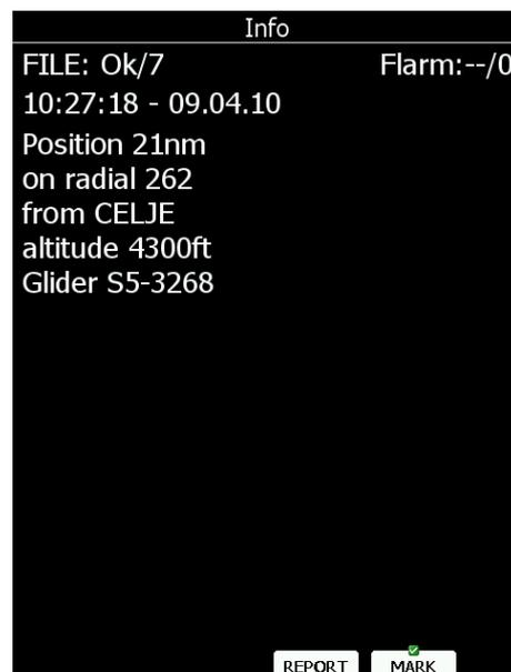
Radials sind immer magnetisch, und die Entfernung wird immer in nautischen Meilen (NM) angegeben, unabhängig von der Einstellung unter Units (3.3.11). Mit „MARK“ wird die aktuelle Position gespeichert, siehe vorangegangener Abschnitt.
