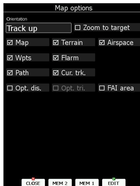
Wenn **Zoom to target** aktiviert ist, wird die Zoomstufe automatisch so eingestellt, daß das Ziel immer sichtbar ist. D.h. die Zoomstufen werden 200km (Maximum) bis zum Erreichen des Ziels auf 1km (Minimum) heruntergestellt. Wird zwischendrin jedoch manuell gezoomt, so wird der automatische Zoom beendet.
